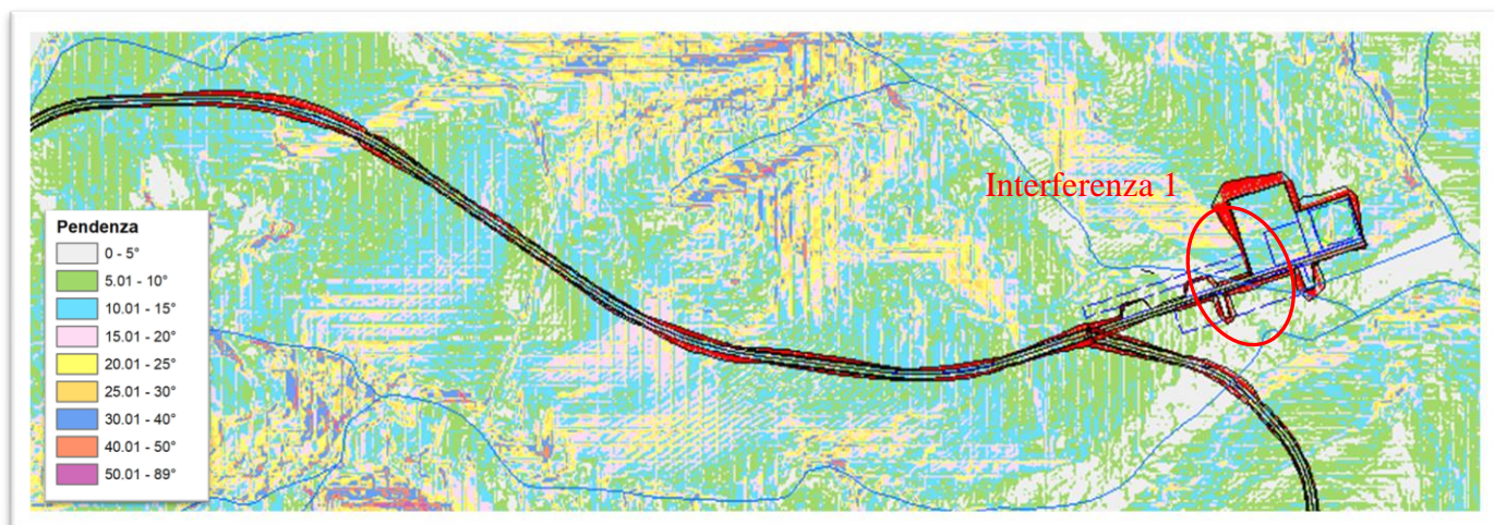
Carta delle pendenze tracciato stradale WTG04
