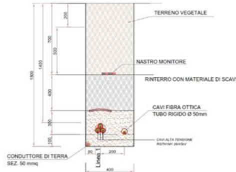
*Figura 10 – Sezioni di scavo Cavo AT su terreno*
