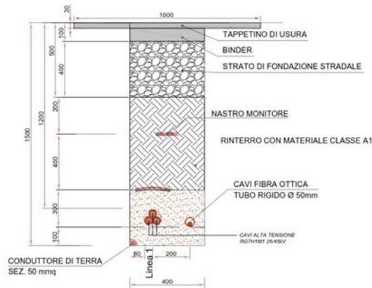
*Figura 8 – Sezione di scavo Cavo AT su strada asfaltata*
