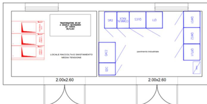
Figura 13 – Tipico Cabina di raccolta e smistamento
