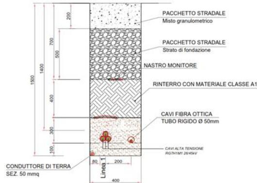
*Figura 9 – Sezione di scavo Cavo AT su strada sterrata*
