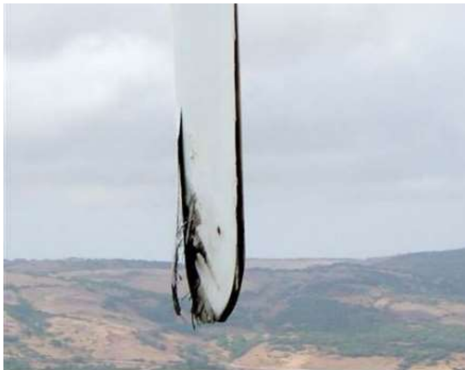
Figura 5 - Estremità di pala danneggiata da fulminazione atmosferica
