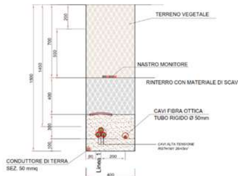
Figura 12 – Sezione di scavo Cavo AT su terreno
