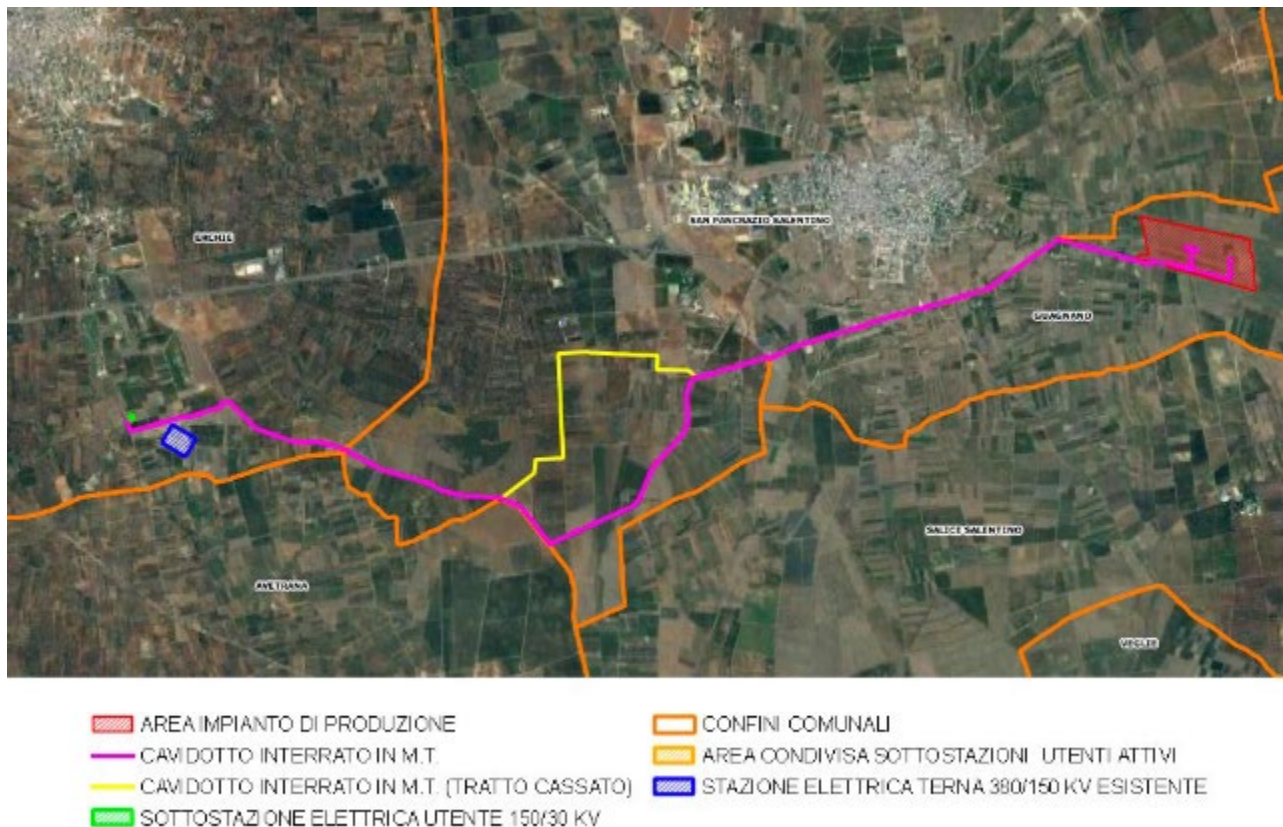
Figura 1: Inquadramento generale delle opere su base Ortofoto
