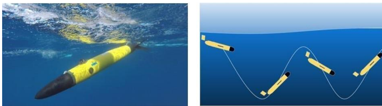
Figura 5. Piattaforma Glider tipo e simulazione delle traiettorie effettuate in colonna d'acqua
