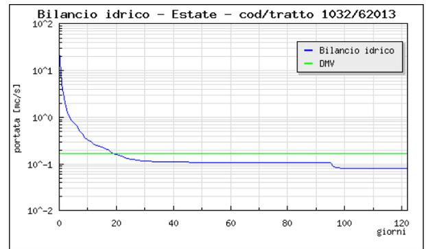
Figura 151 - Chiana Media - a monte della confluenza Allacciante di sinistra – Classe criticità 4 (deficit idrico molto elevato)
