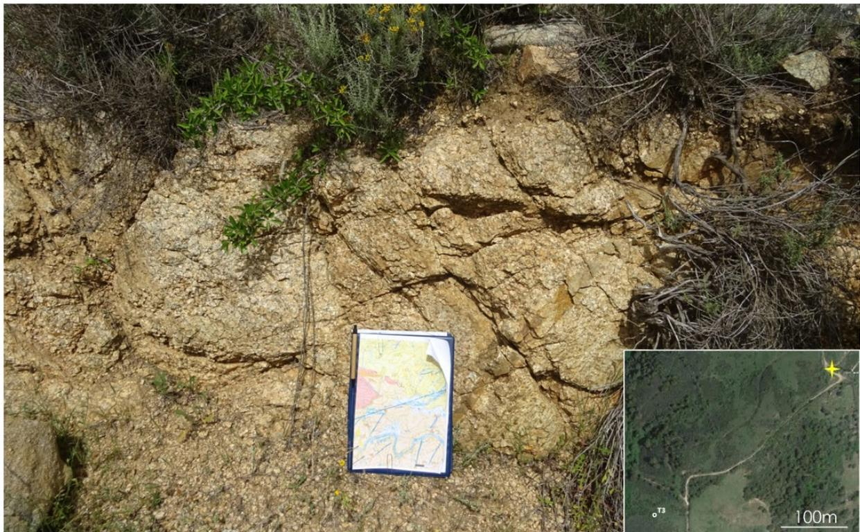
**Figura 3-5: condizione di arenizzazione delle rocce granitoidi nei pressi della postazione WTG T3; L'affioramento è ubicato con puntale giallo nella k-map allegata**
