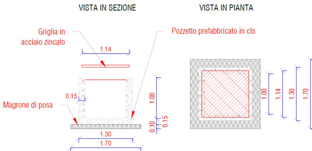
**Figura 6-7 Particolare Pozzetto in calcestruzzo attraversamento**
