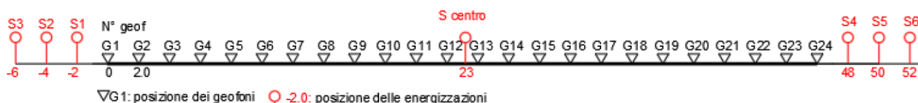
Figura 21 Schema geometrico di acquisizione dei dati per gli stendimenti di lunghezza L = 46,0 m
