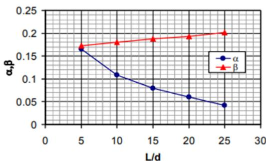
La resistenza laterale  $S$  si ricava in maniera differente a seconda della tipologia di terreno, in generale, si ottiene sommando un addendo relativo all'adesione ( $a$ ) con uno relativo al coefficiente d'attrito fra palo e terreno ( $\mu$ ) moltiplicato per la tensione orizzontale  $\sigma_h$  agente alla generica profondità  $z$ , come segue:
