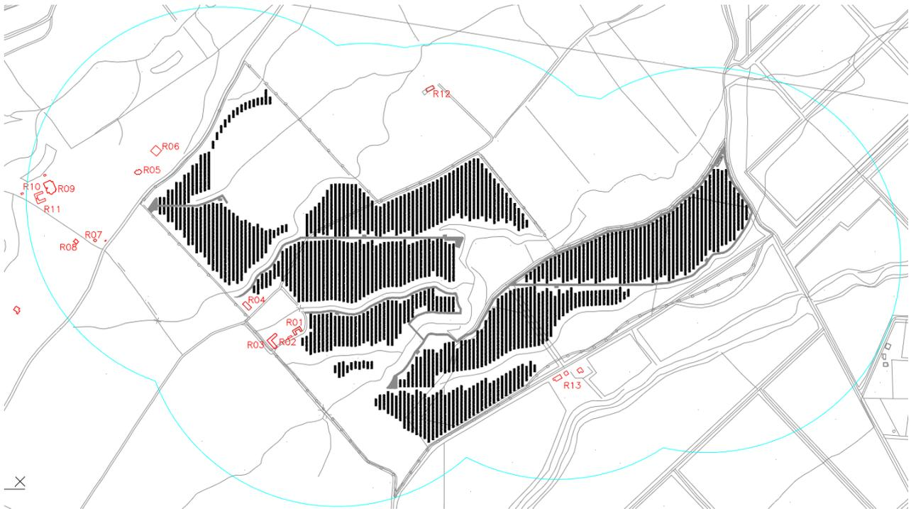
*Figura 8 – Individuazione dei ricettori all'interno del buffer di 500 m (linea ciano) dalle sorgenti sonore dell'impianto fotovoltaico*
