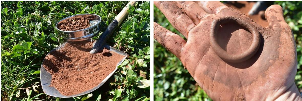
Figure 1 – A sinistra valutazione scheletro e setacciatura della frazione fine. A destra test della tessitura
