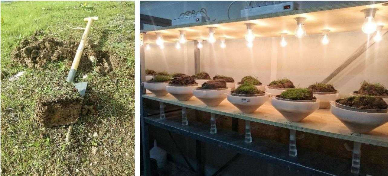
*Figura 48 - A sinistra fasi di prelievo di una zolla di terra per l'analisi del QBS-ar, a destra fase di essiccazione delle zolle e cattura dei microartropodi.*
