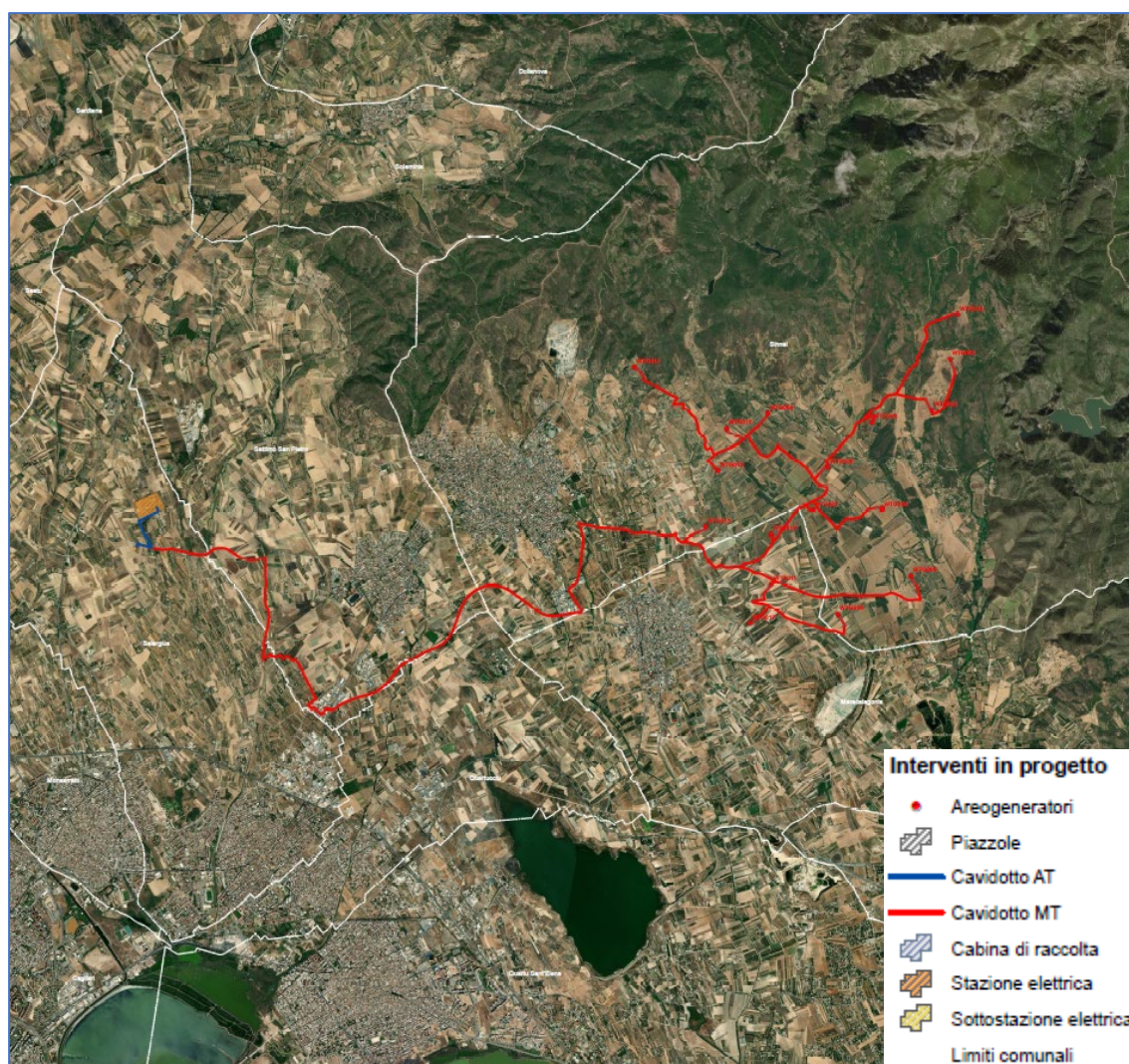
Figura 6 - Inquadramento dell'area di intervento con la posizione degli aerogeneratori e delle opere di connessione
