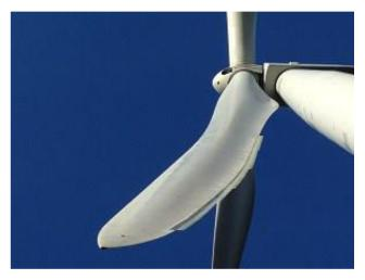
Ciascuna pala è dotata, di un sistema di protezione antifulmine, munito di ricettore che convoglia l'energia verso il circuito di messa a terra della macchina al fine di salvaguardare la sicurezza e lo stato delle apparecchiature.
