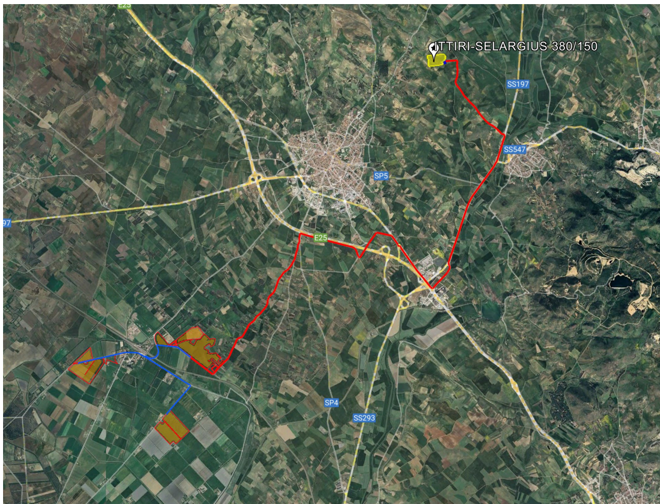
Figura 2 - Tracciato cavidotti MT verso SE
