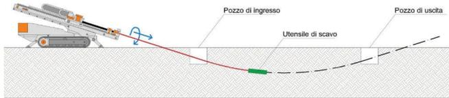
2) Perforazione pilota (pilot bore): mediante una macchina operatrice si realizza una perforazione normalmente di piccolo diametro che viene manovrata attraverso la combinazione di rotazioni e spinte il cui effetto, sulla traiettoria seguita dall'utensile di scavo, è controllata attraverso un sistema di guida radiocontrollato. La perforazione pilota può seguire percorsi piano-altimetrici preassegnati che possono contenere anche tratti curvilinei.
