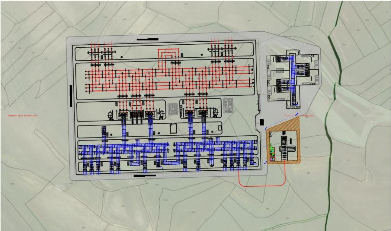
La stazione elettrica utente sarà dotata di un trasformatore di potenza con relativi edifici tecnici adibiti al controllo e alla misura dell'energia prodotta ed immessa in rete.
