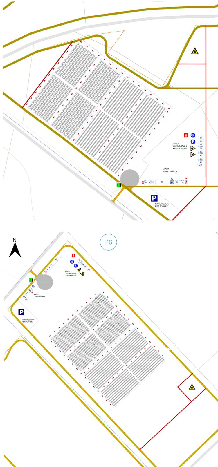
Figura 3 - Ricezione, stoccaggio e movimentazione materiali, dettaglio apprestamenti
