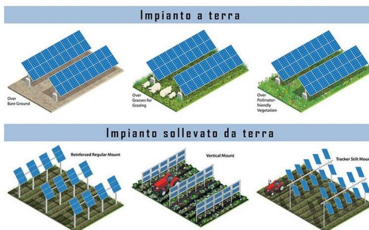
Figura 18 - Tipologie di impianti agrivoltaici, fonte NREL
