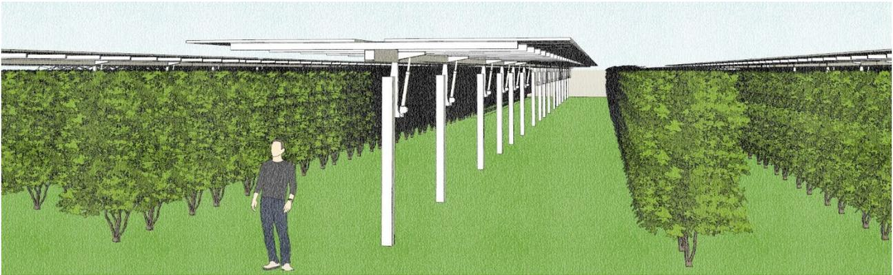
*Figura 88 - Esempio con pannelli orizzontali*
