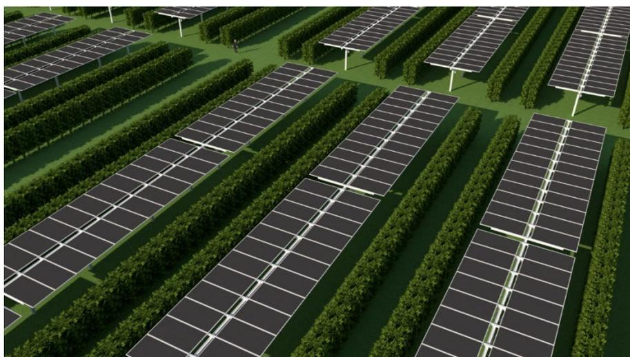
*Figura 78 - Particolare del modello, siepi ulivicole e tracker in posizione orizzontale*
