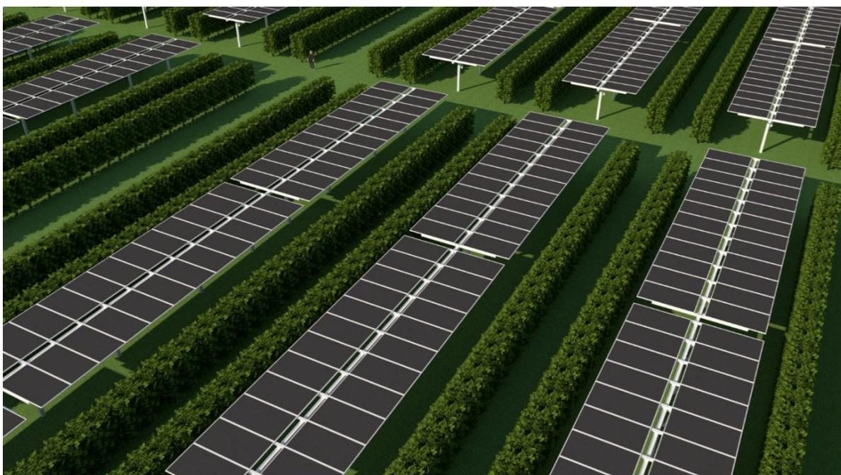
Figura 18- Schizzo dell'assetto impiantistico: un filare FV e due siepi ulivicole alternate
