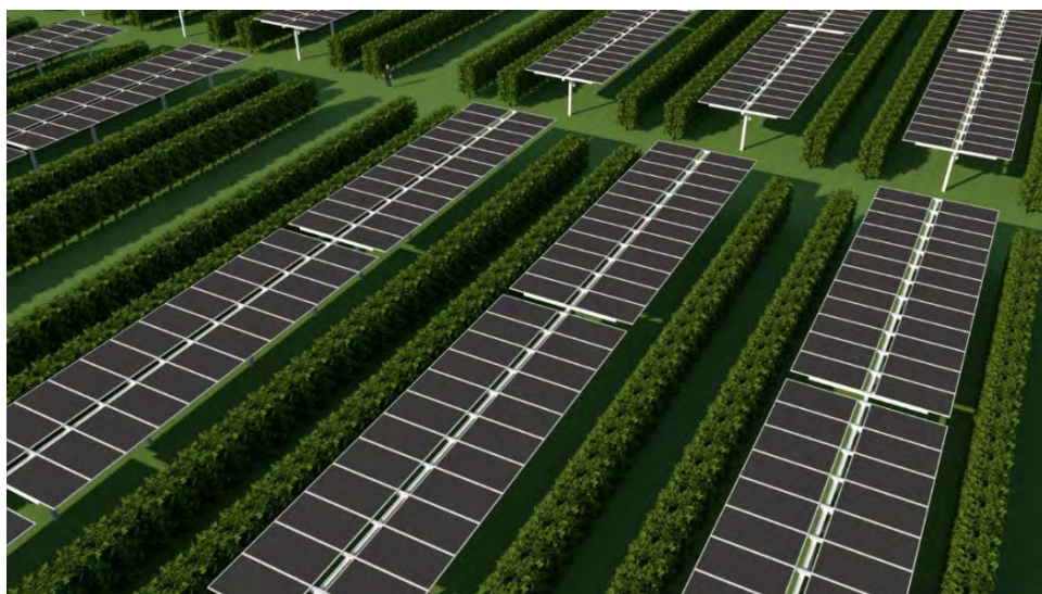
Figura 113 - Particolare del modello, siepi ulivicole e tracker in posizione orizzontale
