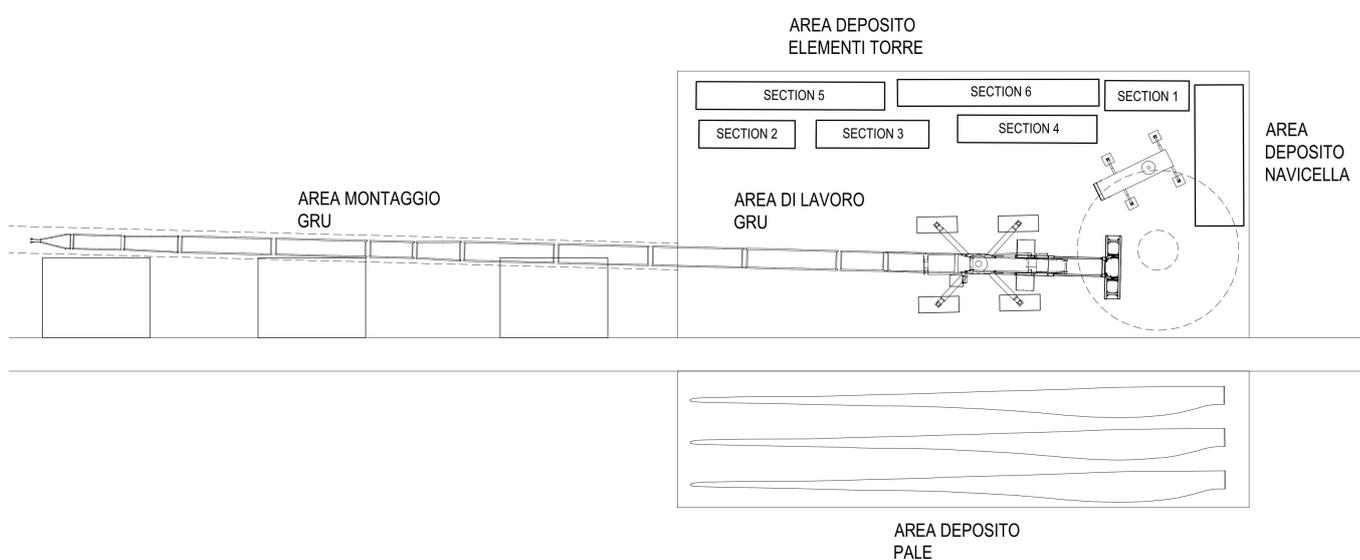
Figura 18: Schema tipo piazzola di montaggio
