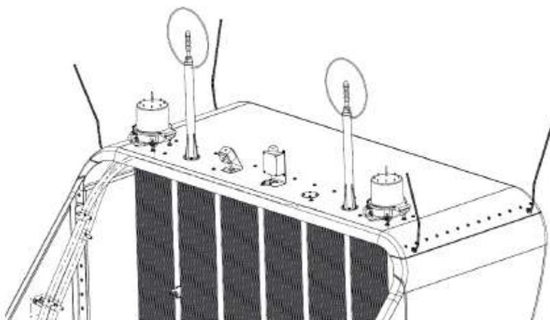
*Figura 5: Anemometri ad ultrasuoni e luci di segnalazione aerea posti sulla parte posteriore del tetto della navicella*
