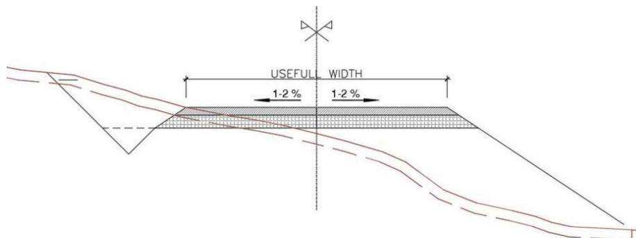
Figura 9: Sezione stradale tipo
