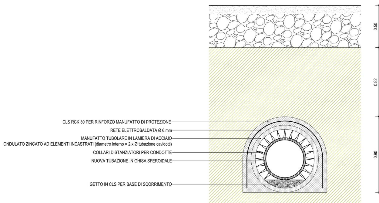
Figura 22: Dettaglio attraversamento di condotte irrigue
