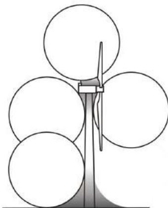
*Figura 4: Metodo delle sfere rotanti*
