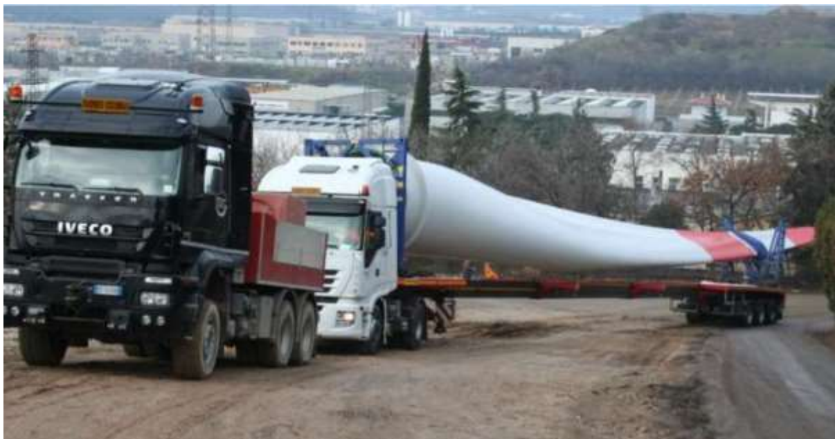
Figura 3—7 Esempio di traino di un Semirimorchio a collo d’oca durante il cantiere.
