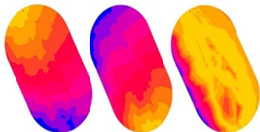
Figura 5-2 Funzione "cost weighted distance" calcolata rispetto alla stazione di origine (a), rispetto alla stazione di destinazione (b) e somma (c).
