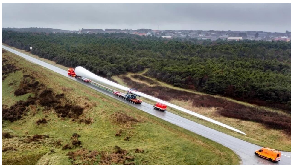
Figure 13 – Trasporto sezione pala
