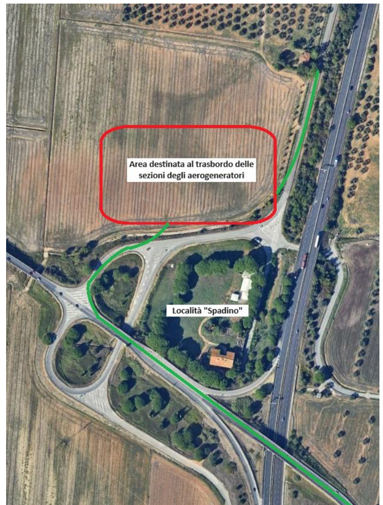
Figure 14 – Area di trasbordo delle sezioni degli aerogeneratori
