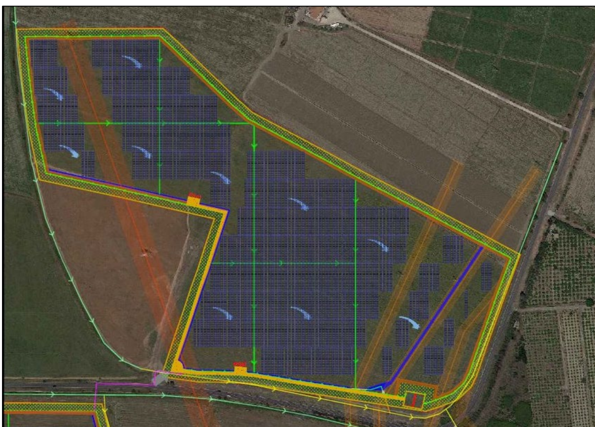
Figura 3.12 - Area di progetto: sistema di canalizzazione artificiale da realizzare (verde) all'interno del PLOT NORTH.
