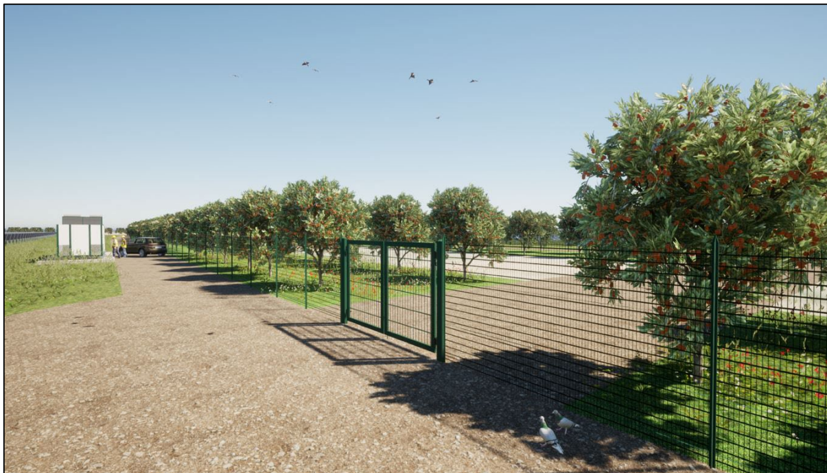
Figura 7.1 – Fotosimulazione con gli interventi di mitigazione previsti, vista dalla SP106: barriera verde con esemplari arborei e rete metallica. Si noti come l'applicazione di del sesto proposto (5 x 5 metri) e le effettive dimensioni di un albero adulto mascherino completamente l'impianto dalle brevi distanze.
