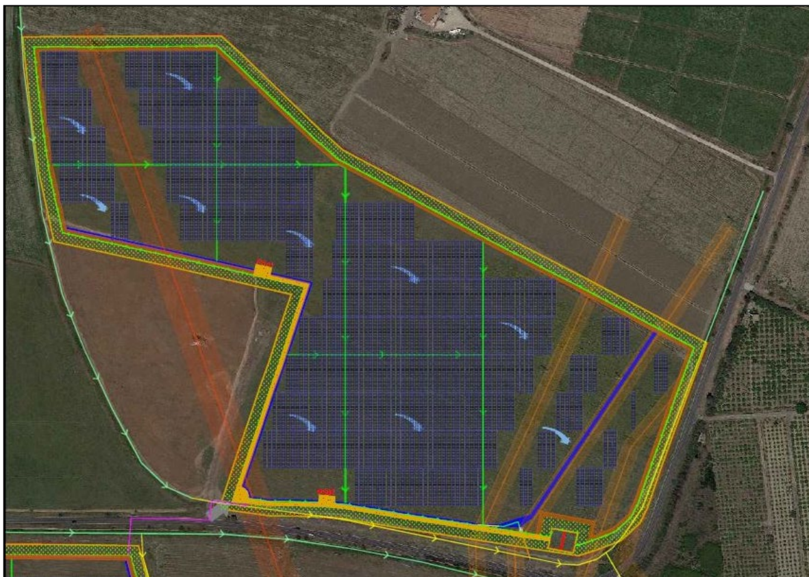
Figura 3.18 - Area di progetto: sistema di canalizzazione artificiale da realizzare (verde) all'interno del PLOT NORTH.
