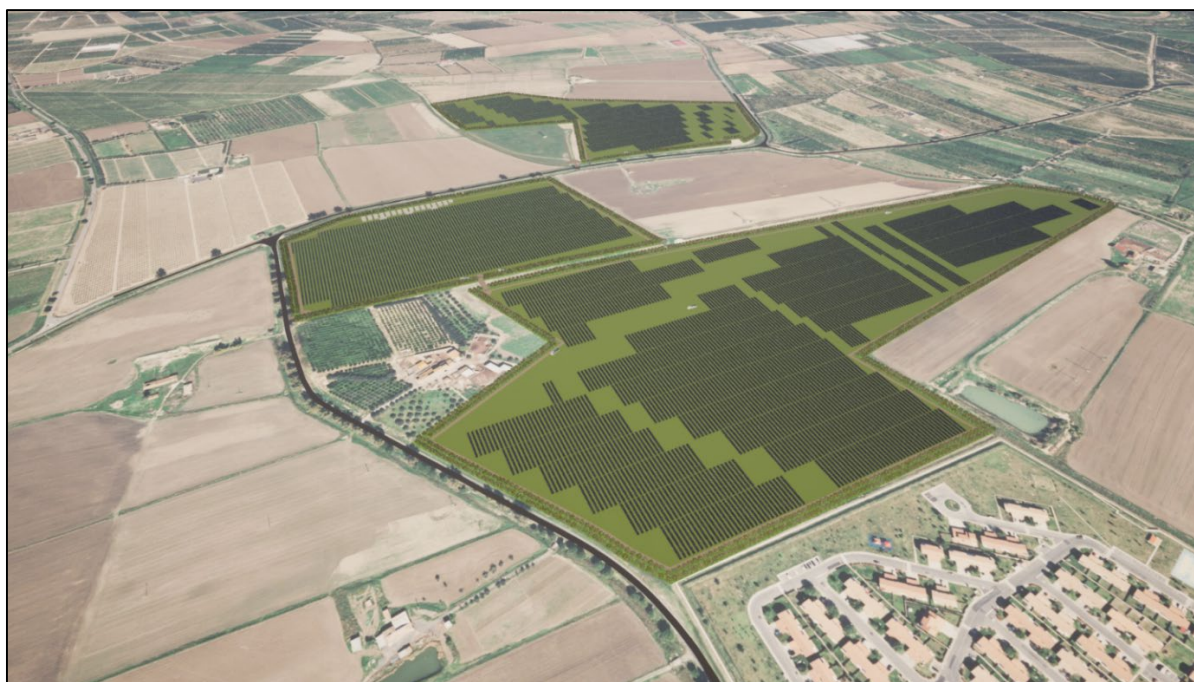
Figura 5.2 - Rendering indicativo e vista dall'alto direzione SO, con distribuzione delle specie arboree costituenti la fascia di mitigazione perimetrale di ampiezza 10 m.
