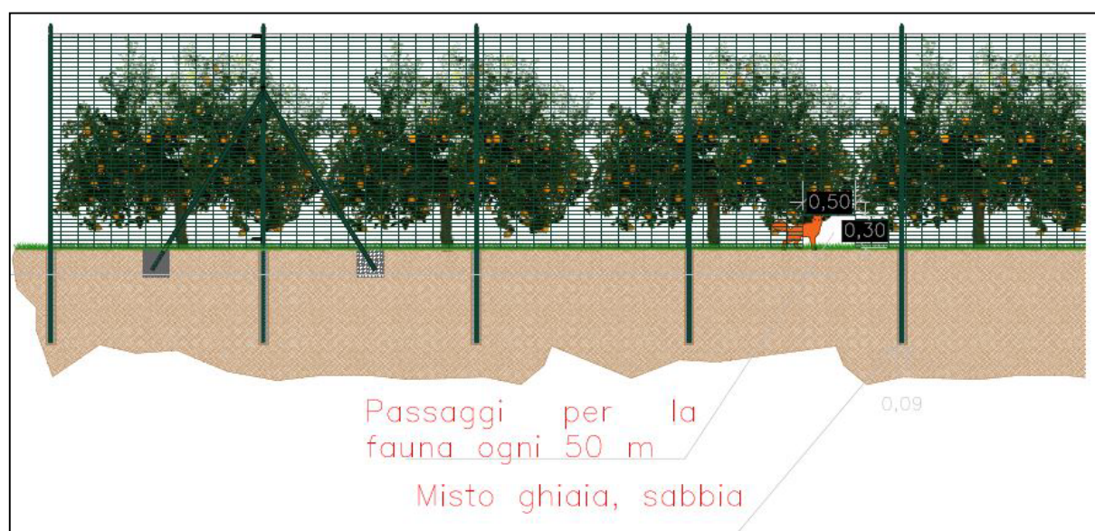
Figura 5.13 - sezione trasversale della recinzione prevista con evidenziati i corridoi ecologici
