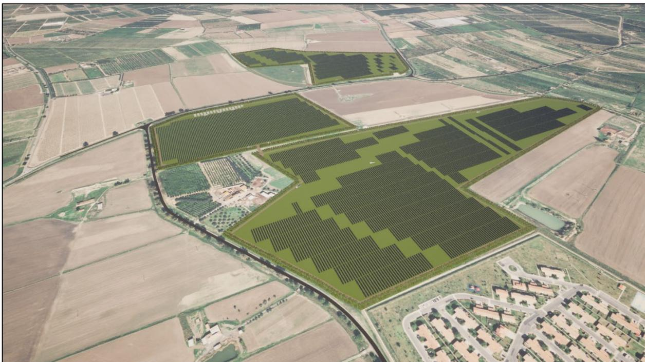
Figura 5.19 - Rendering indicativo e vista dall’alto direzione SO, con distribuzione delle specie arboree costituenti la fascia di mitigazione perimetrale di ampiezza 10 m.
