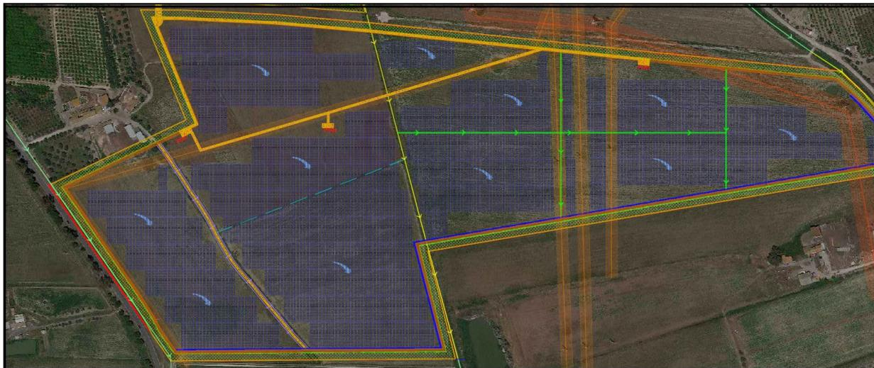
Figura 3.18 - Area di progetto: sistema di canalizzazione artificiale esistente (celeste) e sistema di canalizzazione da realizzare (verde) all'interno del PLOT SUD.
