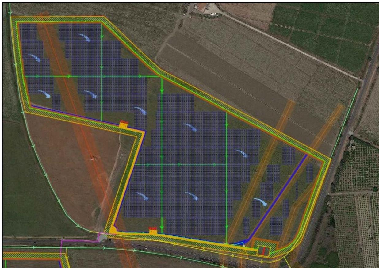
Figura 3.16 Area di progetto: sistema di canalizzazione artificiale da realizzare (verde) all'interno del PLOT NORTH.
