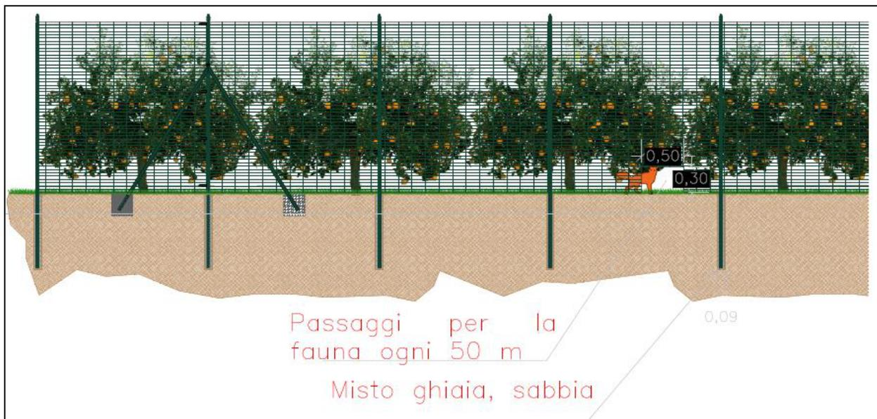
Figura 5.32 Sezione trasversale della recinzione prevista con evidenziati i passaggi per la fauna.
