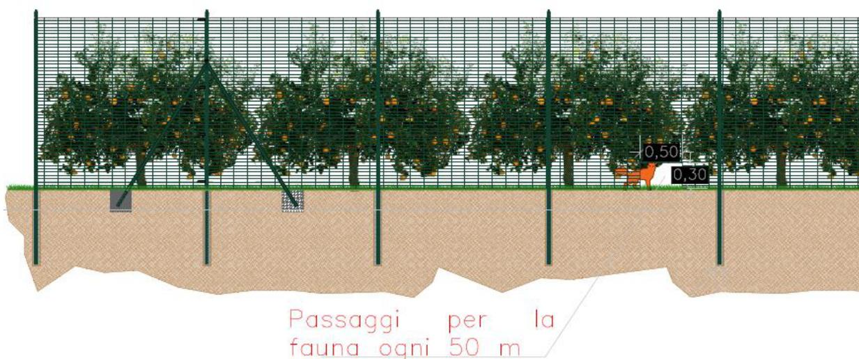
Figura 5.17 - Sezione trasversale della recinzione prevista con evidenziati i passaggi per la fauna.
