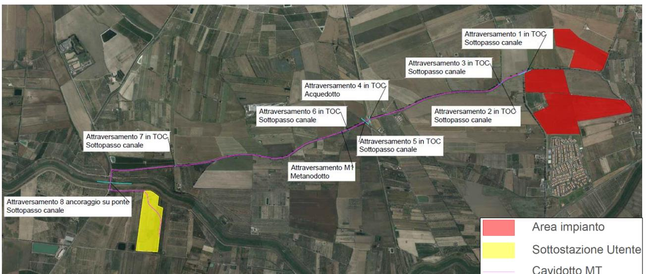
Figura 11 Tracciato del cavidotto su ortofoto - Ubicazione interferenze - Estratto dall'elaborato progettuale “Monografie sulle interferenze del cavidotto”
