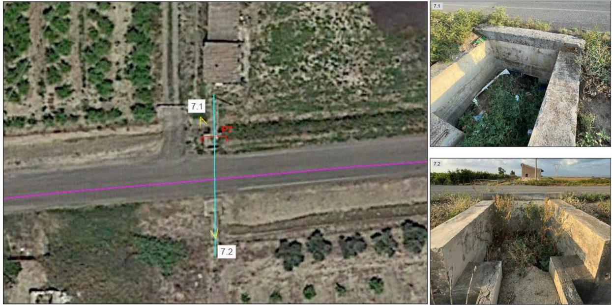
Figura 20 Attraversamento idraulico n.7 - Stralcio su ortofoto e foto
