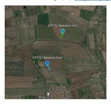
Dai risultati delle indagini elettriche effettuate nei siti indicati non si evince la presenza di cavità sotterrane. Il report delle tomografia elettrica si riporta in allegato.
