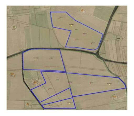
Le stratigrafie rinvenute nei sondaggi effettuati, (n. 7 perforazioni, approfonditi a 5,0 m o 10,00 m dal p.c.), sono di seguito riportati.
