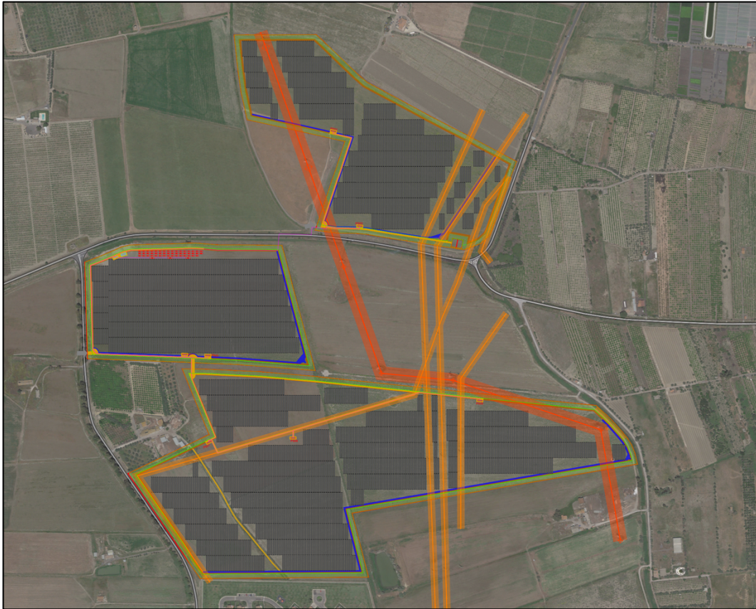
Figura 4 - Layout dell'impianto completo su ortofoto con identificazione delle fasce di mitigazione (in verde)
