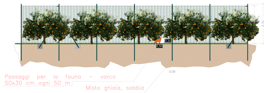
Figura 10 - Particolare delle aperture nelle recinzioni
