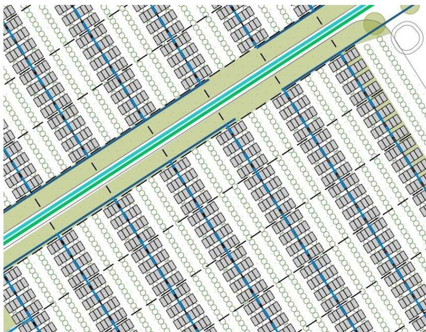
Percorso cavi solari BT di stringa su strutture di supporto dei tracker installati
