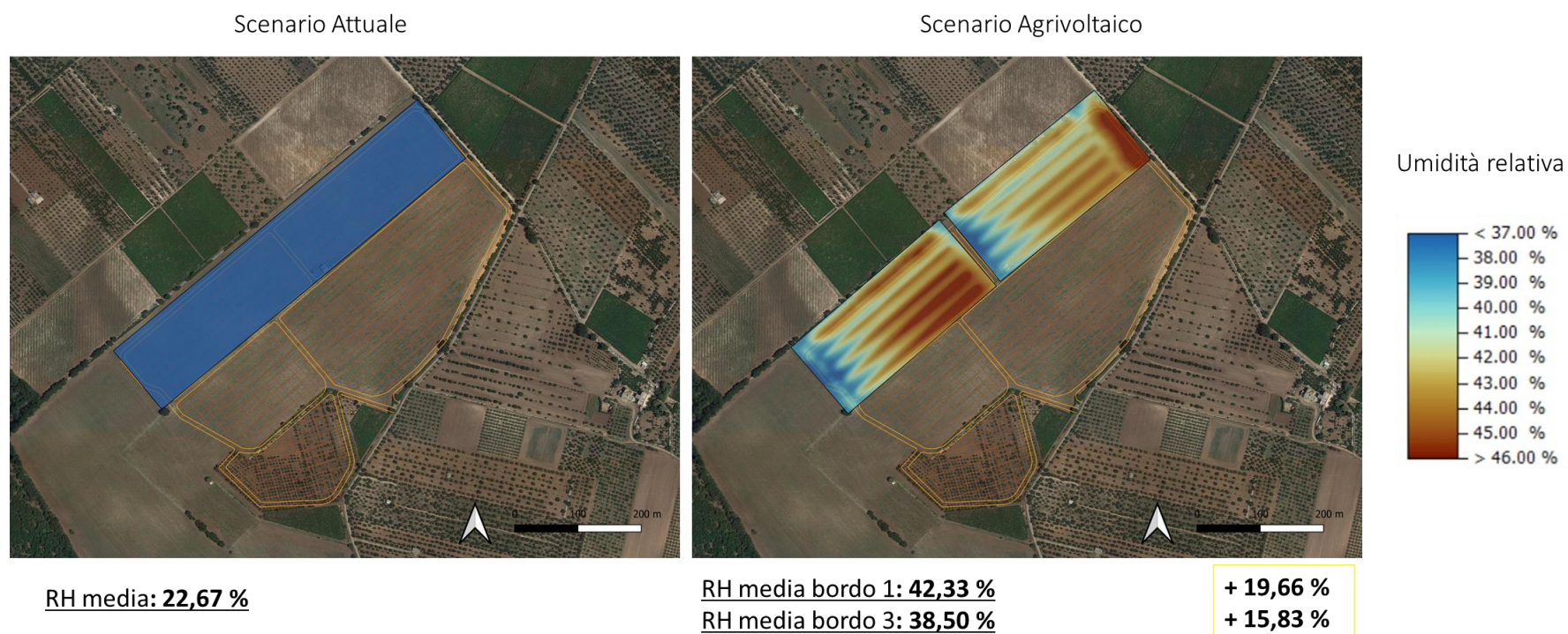
Figura 16: Mappe di distribuzione spaziale di RH estratte alle 12:00 ad un'altezza pedestre di 1.4m.
