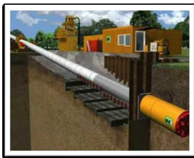
Figure 2-13. Schema tecnica "Microtunneling"
