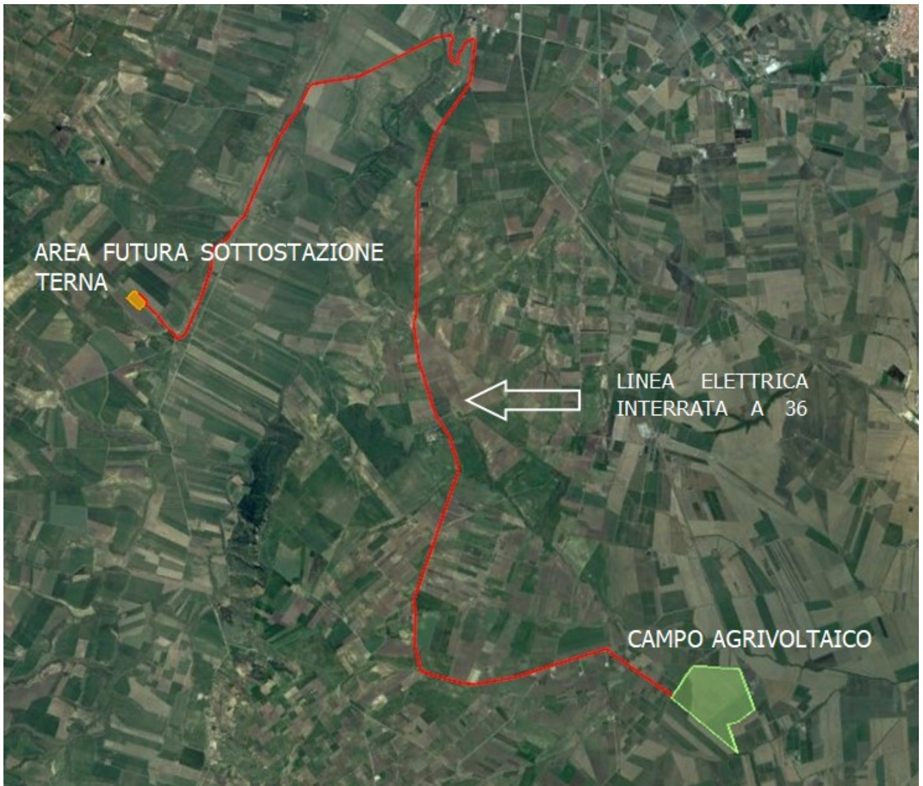
Figure 1-6. Vista d'insieme dell'impianto con collegamento cavo a 36 kV (in verde)
