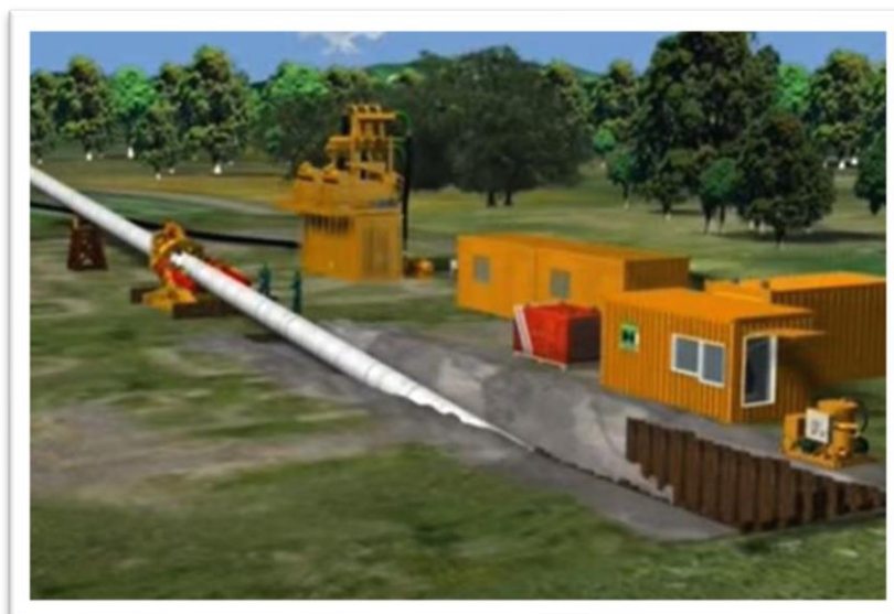
Immagine tecnica "Microtunneling"
