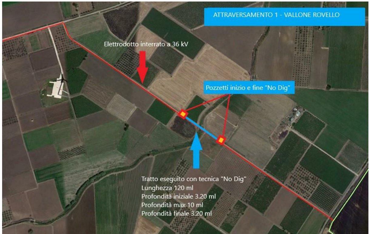
Attraversamento del Vallone Rovello con tecnica "No Dig"
