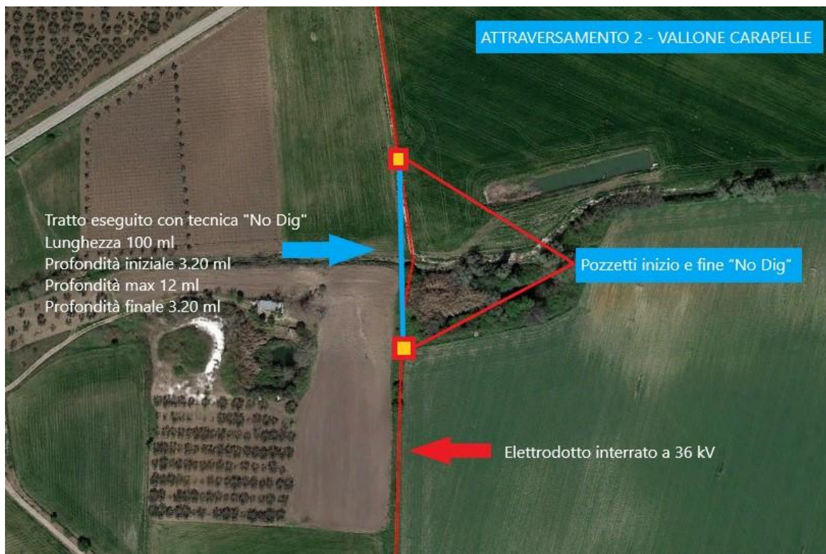
Attraversamento del Vallone Carapelle con tecnica "No Dig"
