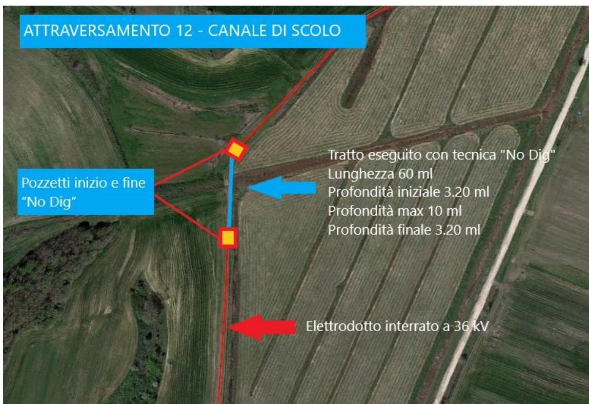
Attraversamento di un canale di scolo con tecnica "No dig"
