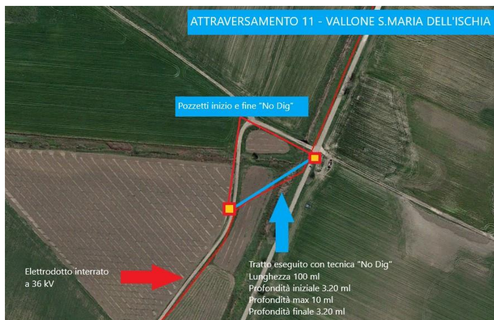
Attraversamento Vallone S.Maria dell'Ischia con tecnica "No dig"
