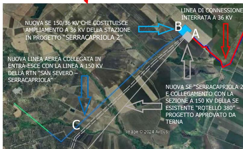
*Rappresentazione schematica delle opere di connessione su base ortofoto*
