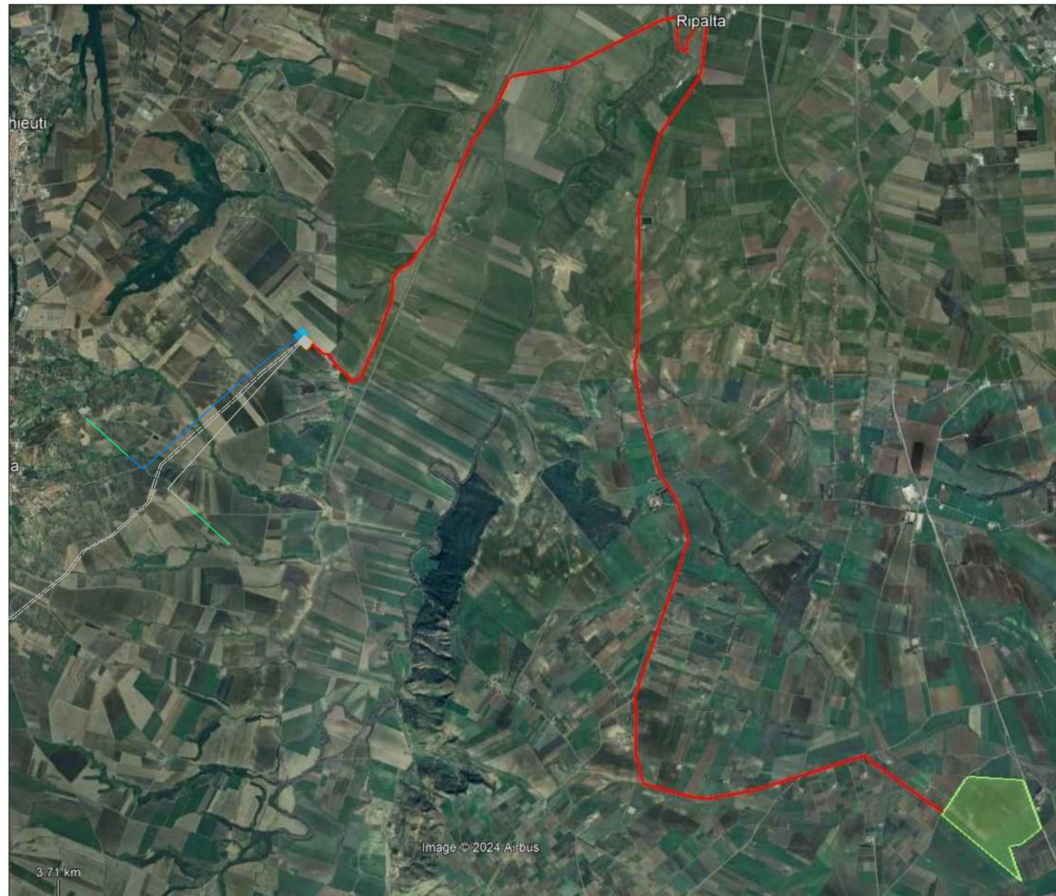
Il sito relativo all'ampliamento della SE "Serracapirola 2" è situato nel comune di Serracapirola (FG). L'ampliamento sarà collegato alla SE "Serracapirola 2" mediante prolungamento delle barre a 150 kV e, tramite elettrodotto aereo, in entra - esce con la linea esistente a 150 kV della RTN "San Severo - Serracapirola".
