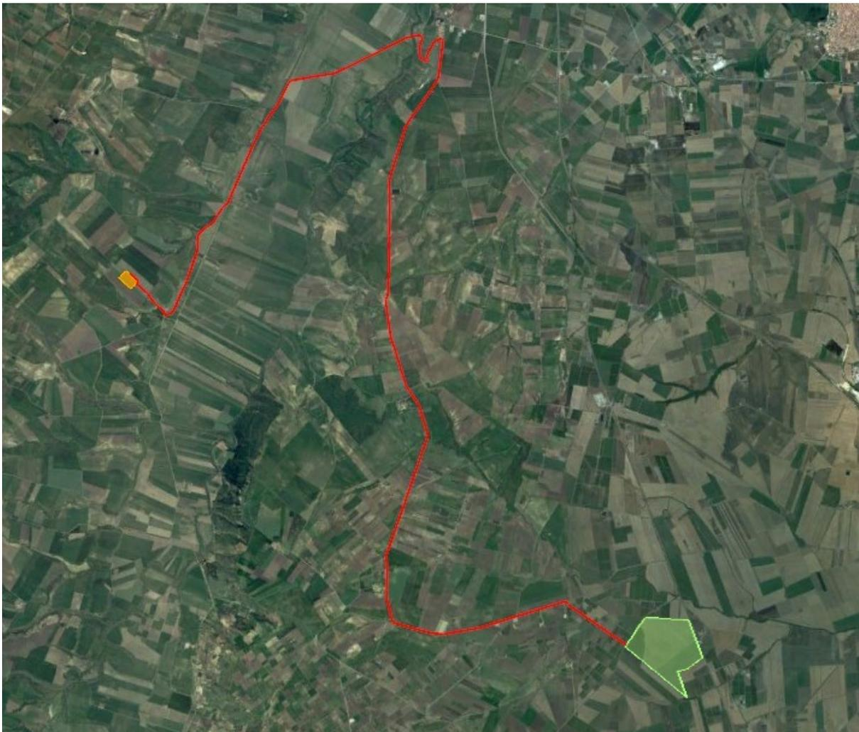
Figure 3-1. Vista d'insieme dell'impianto con collegamento cavo a 36 kV (in rosso)
