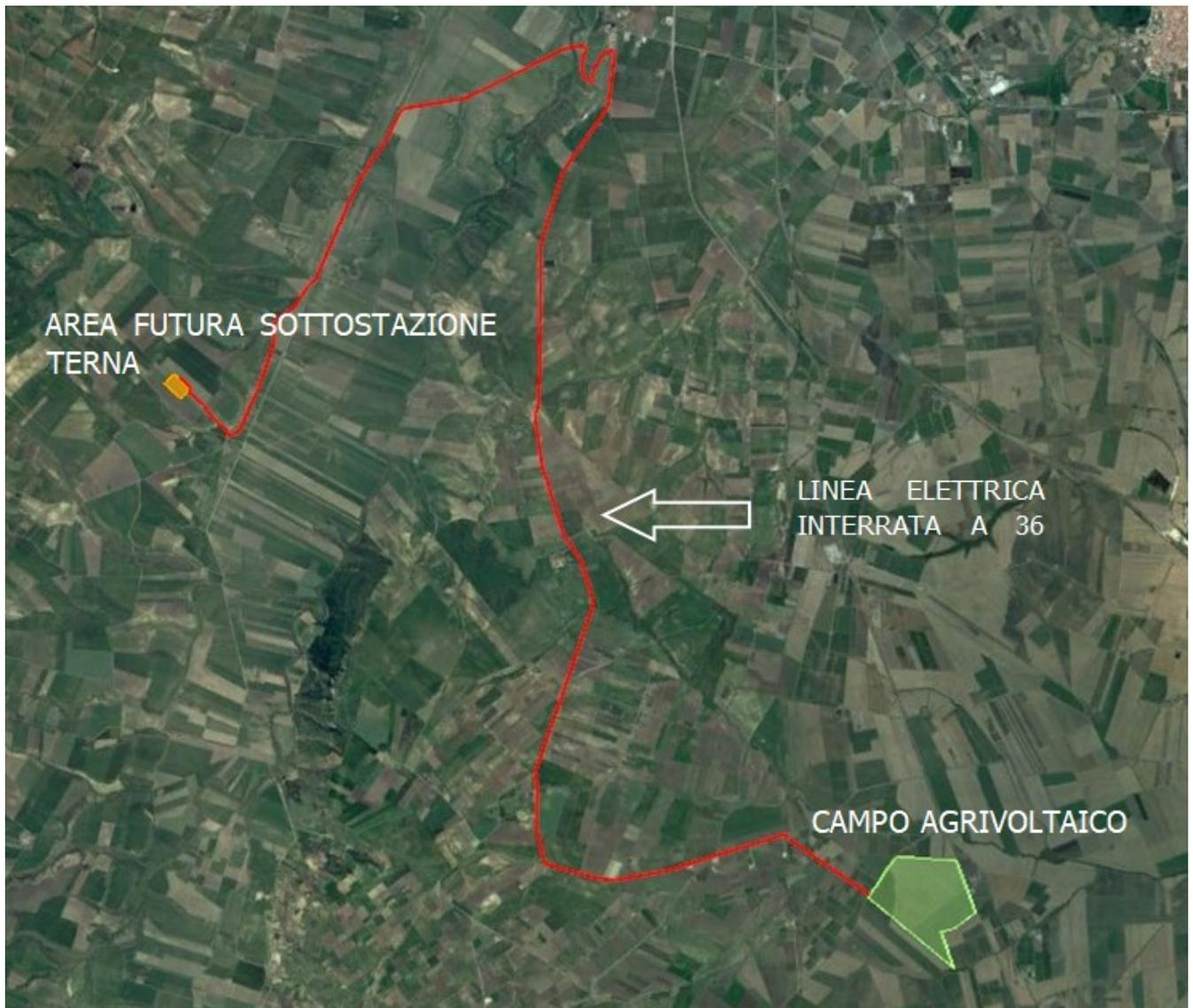
Figure 3-5. Vista d'insieme dell'impianto con collegamento cavo a 36 kV (in verde)
