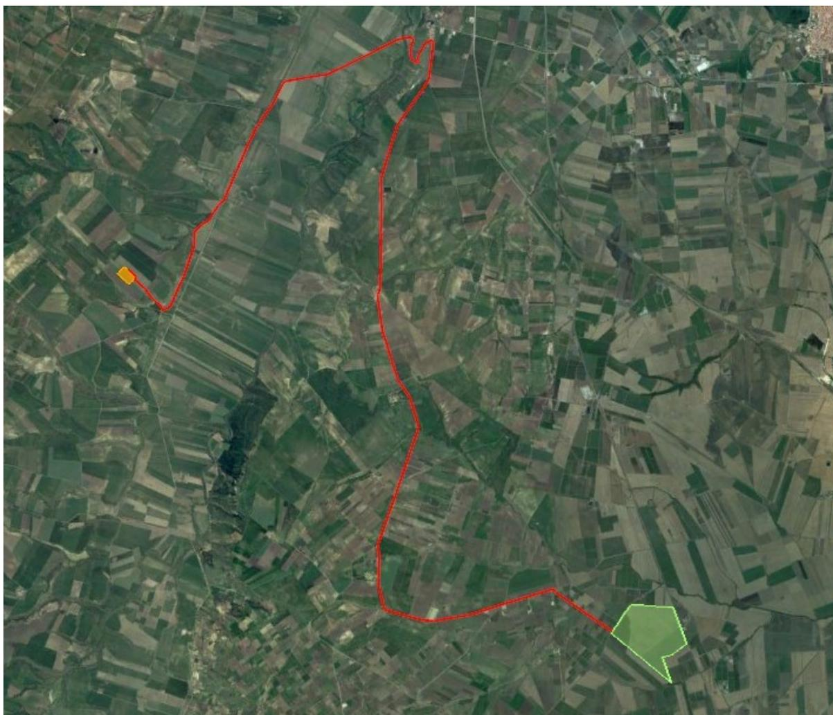
Figure 4-1. Vista d'insieme dell'impianto con collegamento cavo a 36 kV (in rosso)
