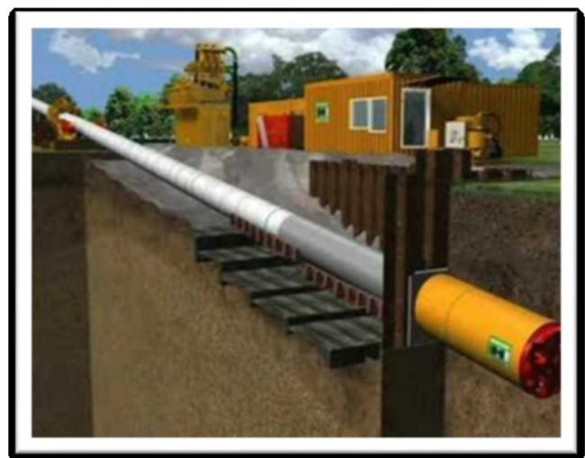
Figure 4-13. Schema tecnica "Microtunneling"
