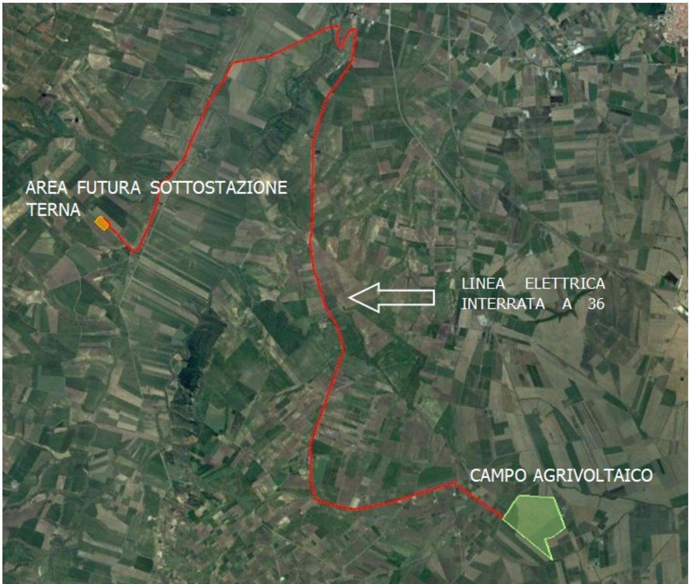
Figure 4-6. Vista d'insieme dell'impianto con collegamento cavo a 36 kV (in verde)
