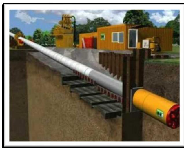
Figure 2-13. Schema tecnica "Microtunneling"
