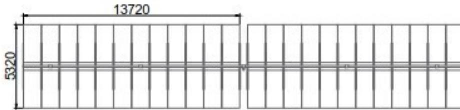
Figure 2-9. Vista laterale e in pianta di due stringhe fotovoltaiche
