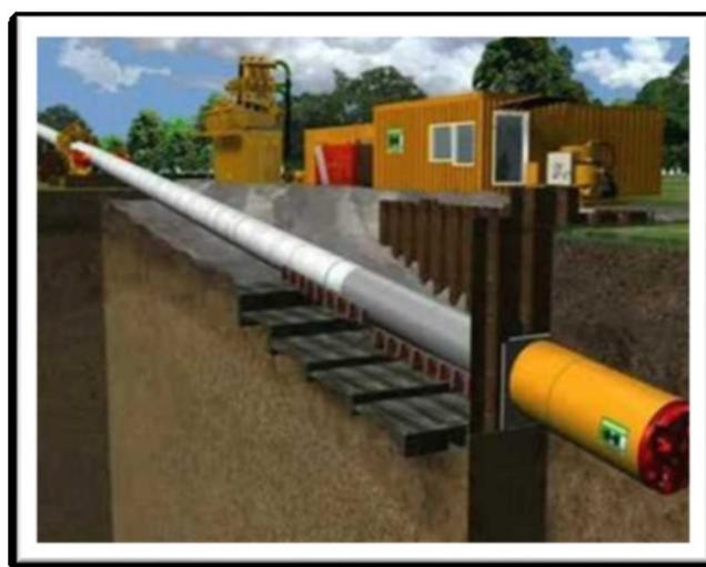
Figure 2-13. Schema tecnica "Microtunneling"
