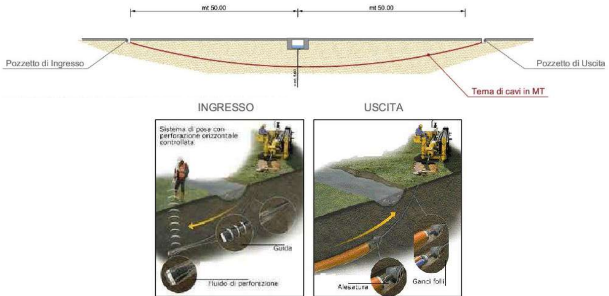
Figura 4-3 Tecnica No Dig
