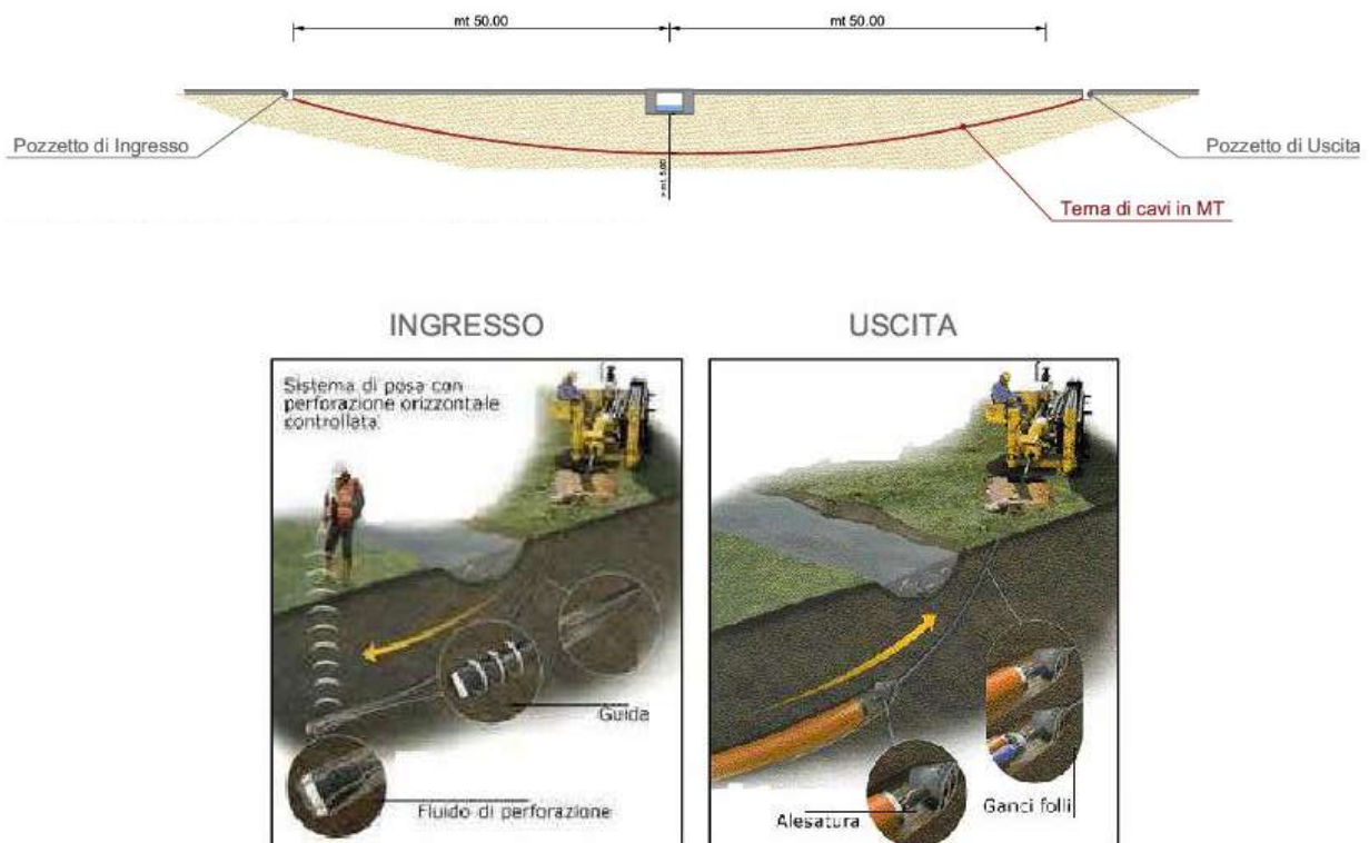
Figura 3-7 Tecnica No Dig
