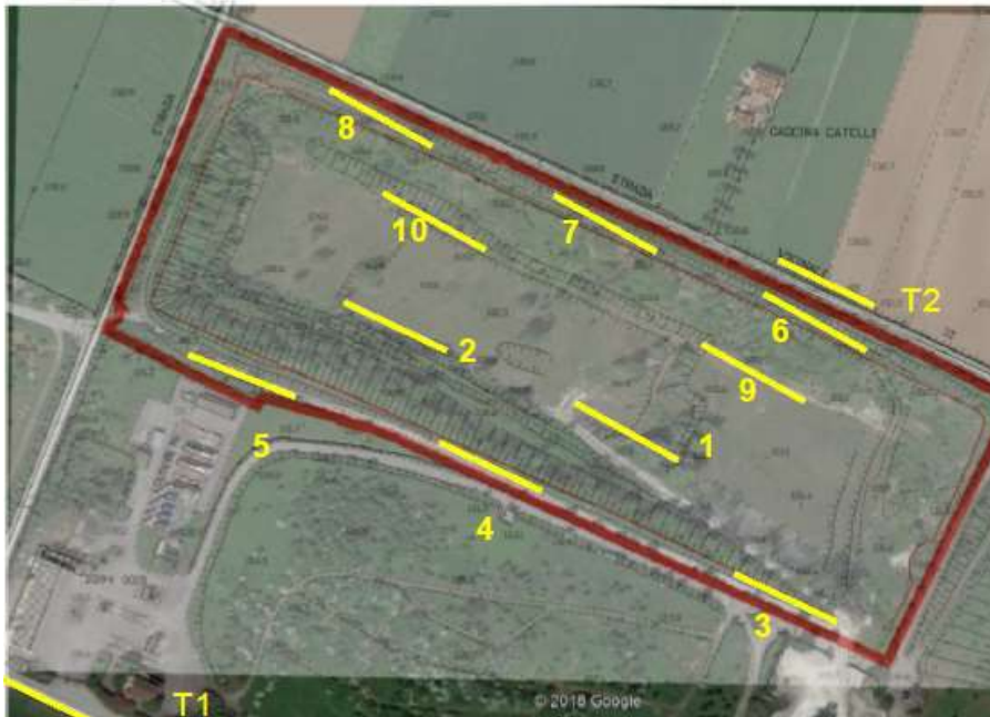
Figura 4 - Ubicazione indagini sismiche
