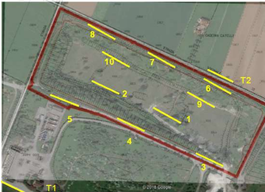
Figura 3 - Ubicazione indagini sismiche
