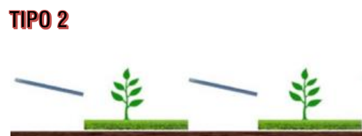
Figura 27. Sistema agrivoltaico in cui la coltivazione avviene tra le file dei moduli fotovoltaici, e non al di sotto di essi
