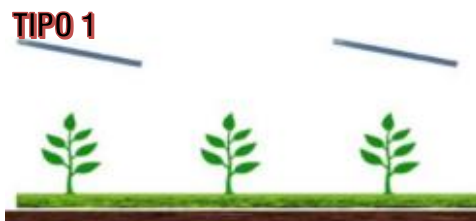
Figura 26. Sistema agrivoltaico in cui la coltivazione avviene tra le file dei moduli fotovoltaici, e sotto a essi
