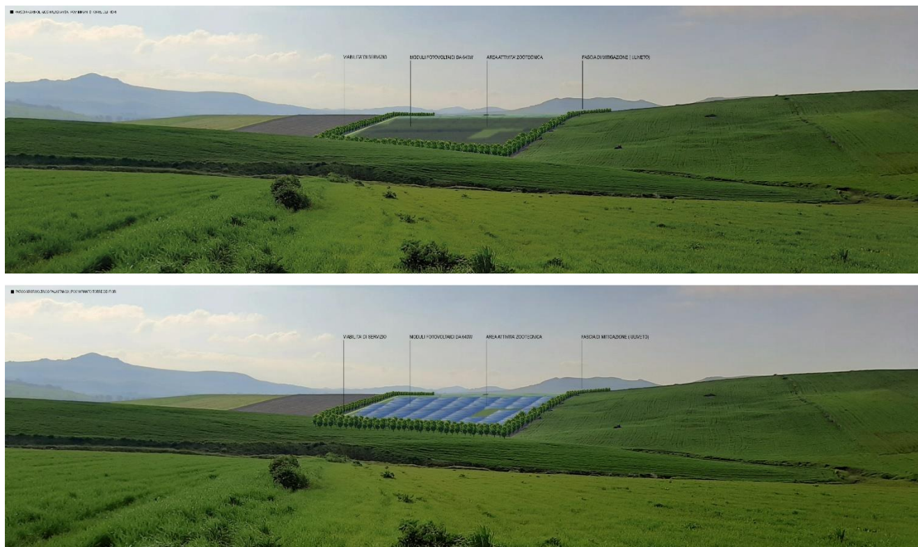
Figura 75. Differenza visivo-percettiva in base alla tipologia di moduli scelta, in basso i moduli in silicio policristallino presentano un maggior impatto estetico e di abbagliamento rispetto alla tecnologia in silicio monocristallino utilizzato per l'impianto Galiello.
