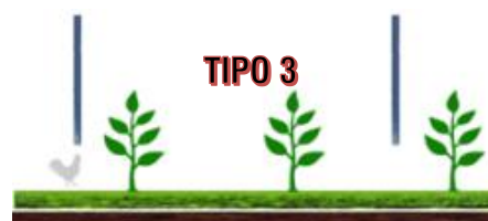
Figura 28. Sistema agrivoltaico in cui i moduli fotovoltaici sono disposti verticalmente. La coltivazione avviene tra le file dei moduli fotovoltaici, l'altezza minima dei moduli da terra influenza il possibile passaggio di animali
