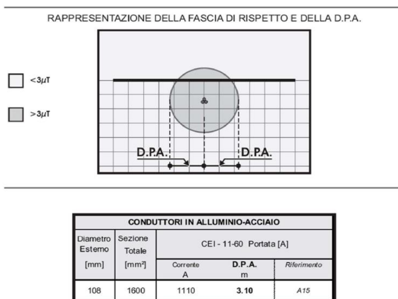
Figura 21: D.P.A per cavidotto interrato secondo norma CEI 11-60
