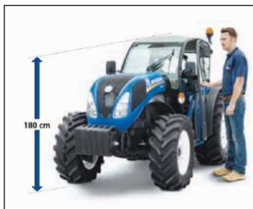
Figura 21. Dimensioni caratteristiche di un trattore da frutteto con cabina ribassata (Fonte: CNH)
